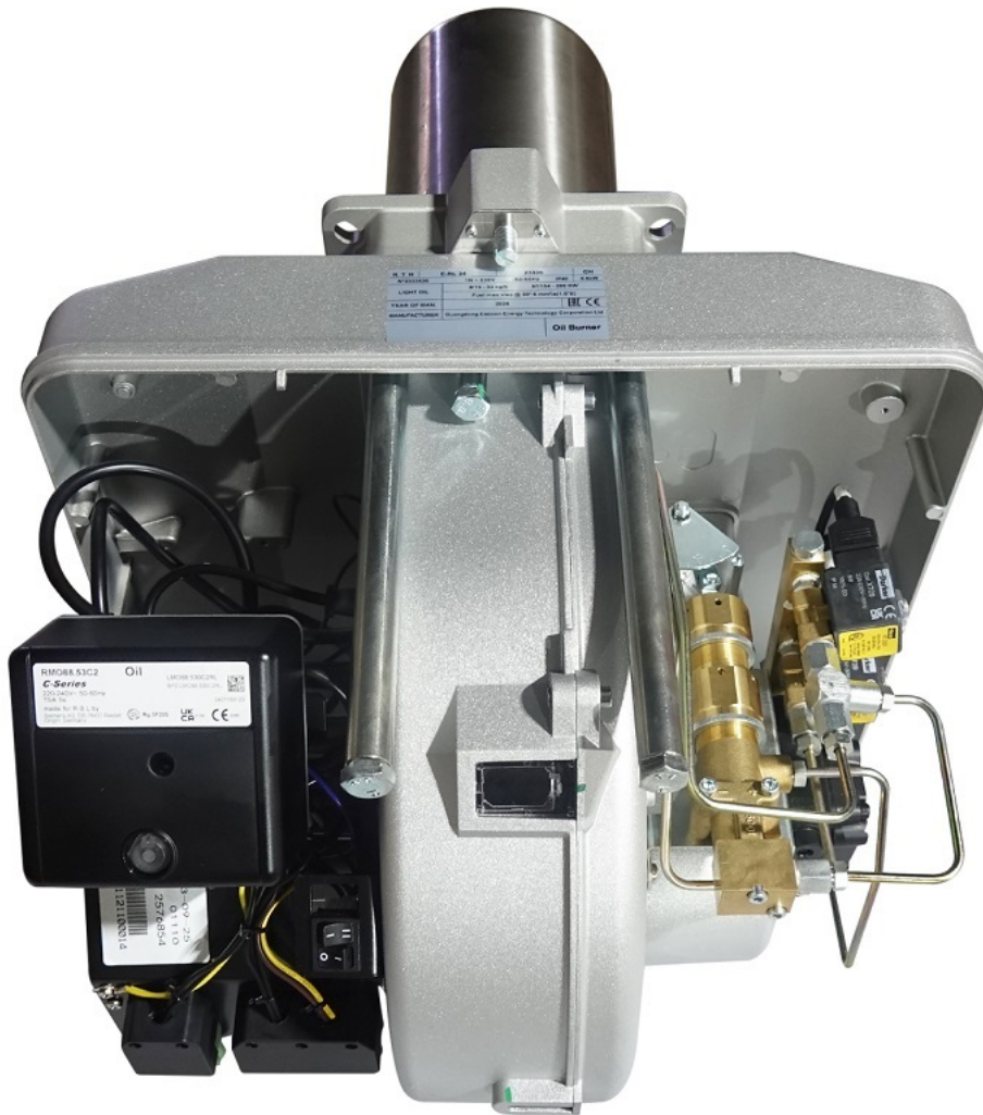
Widok na palnik Eacocon E-RL 44 po ściągnięciu obudowy
